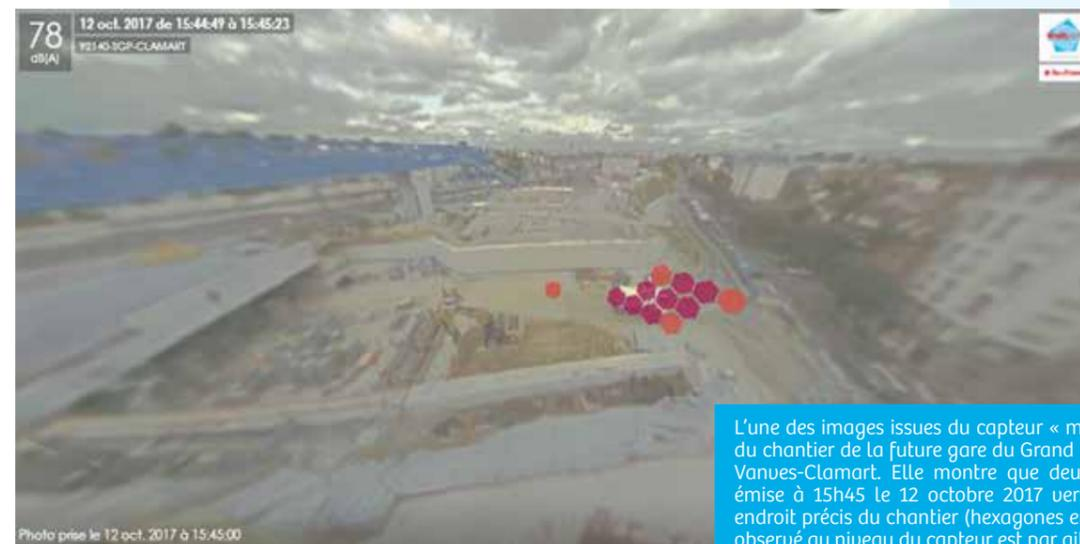
L'une des images issues du capteur « méduse » déployé au niveau du chantier de la future gare du Grand Paris Express de Fort d'Issy-Vanves-Clamart. Elle montre que deux tiers de l'énergie sonore émise à 15h45 le 12 octobre 2017 vers ce capteur provient d'un endroit précis du chantier (hexagones en rouge). Le niveau de bruit observé au niveau du capteur est par ailleurs de 78 dB(A).
